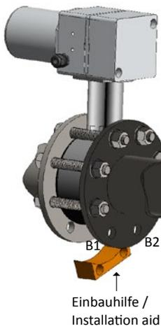
Entfernen Sie nun B1 und B2 wieder, so dass die Einbauhilfe entfernt werden kann.
